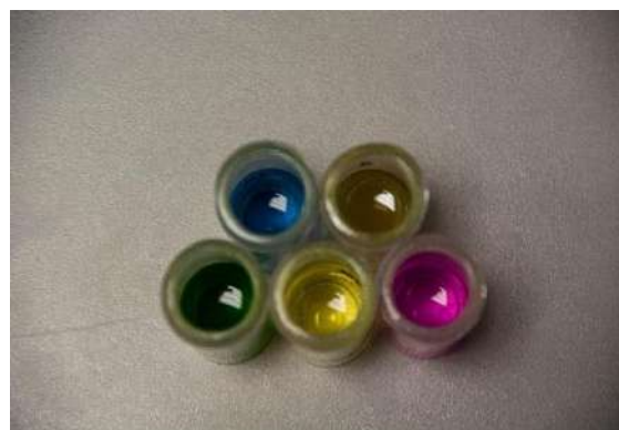
Slika 4: Na podlagi barve lahko določimo pH snovi
