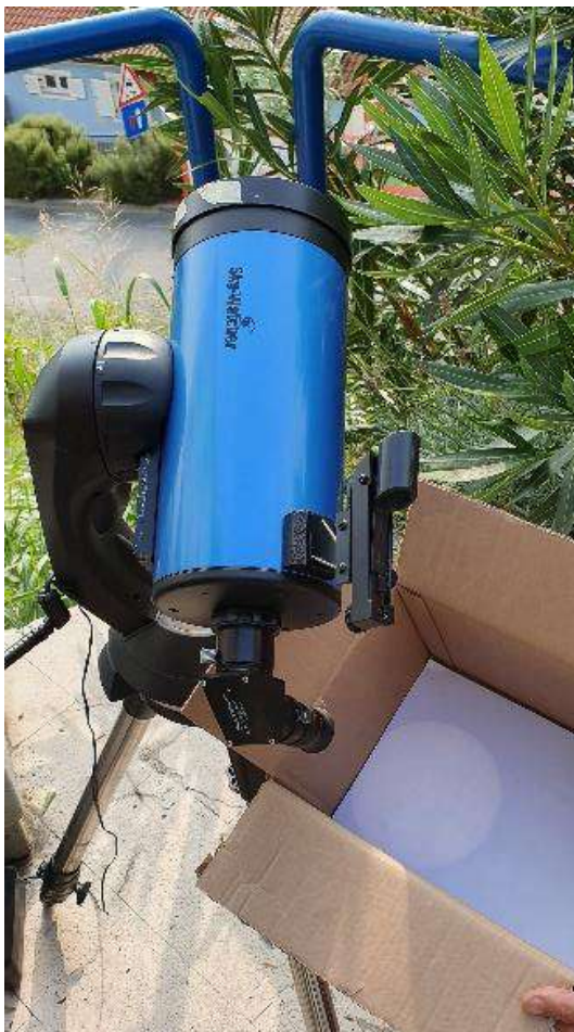
Slika 5: Projekcija Sonca skozi teleskop na list papirja
